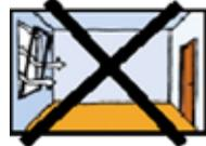
Ein vollständiger Luftwechsel dauert bei gekipptem Fenster bis zu einer Stunde, die Mauern und Möbel rund ums Fenster kühlen ab und die Energieverluste sind enorm. An den kühlen Bauteilen kann Luftfeuchtigkeit kondensieren und zu Schimmelbildung führen, obwohl man „dauernd lüftet“.
